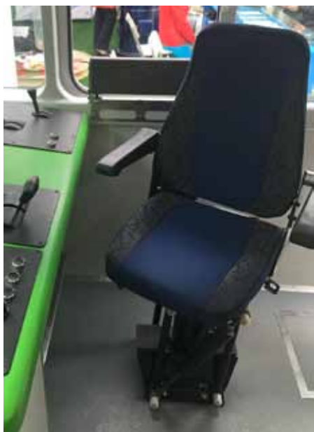
Рис. 1. Кресло машиниста КЛ-7500М.0-02У на подставке параллелограмм ПП.27.Т-0 в кабине производства ЗАО «МЫС»
