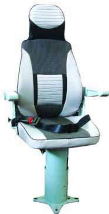
Рис. 3. Кресло машиниста КЛ-7500М.0-02-01 с двухточечным статическим поясным ремнем безопасности
